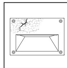
**ITA.** Durante il montaggio e la manutenzione degli apparecchi è necessario prestare particolare attenzione a non danneggiare la verniciatura a polvere. Un danno combinato all'azione dell'acqua potrebbe provocare la corrosione. I prodotti chimici danneggiano la protezione anticorrosione.
