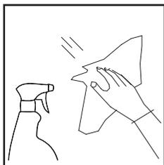
**ITA.** Pulire periodicamente gli apparecchi per rimuovere gli accumuli di sporco che si depositano sulle griglie e nella testa delle viti. Pulire le parti in acciaio utilizzando appositi detergenti. Per la pulizia dell'apparecchio utilizzare un panno morbido e detergente neutro.
