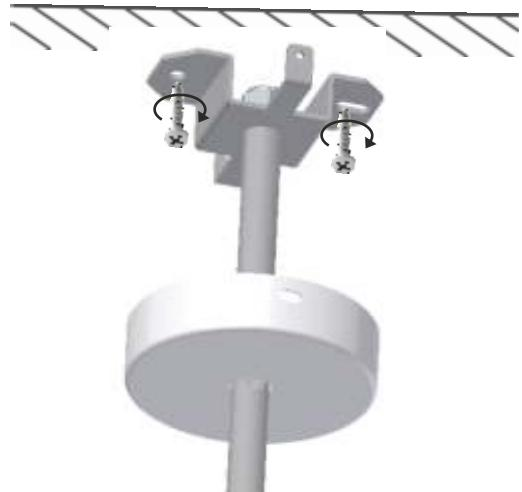
8- Colocar los tapa paredes (E) y enroscar los tornillos laterales. Figura 8.
